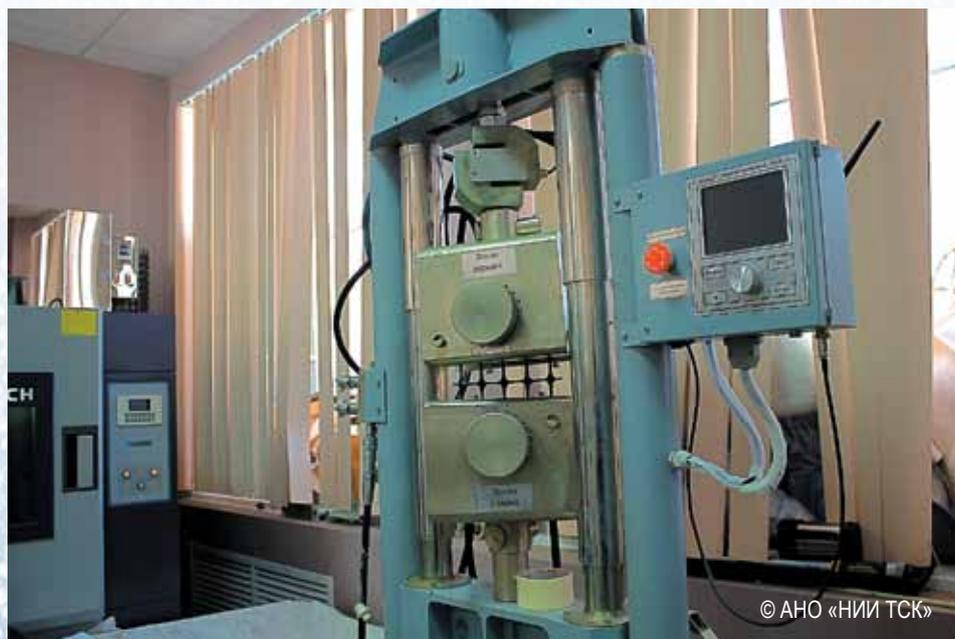
*Испытания на определение прочности георешетки*
