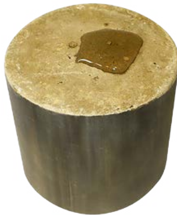
Рис. 1. Пример водонепроницаемости образца из укрепленного грунта
