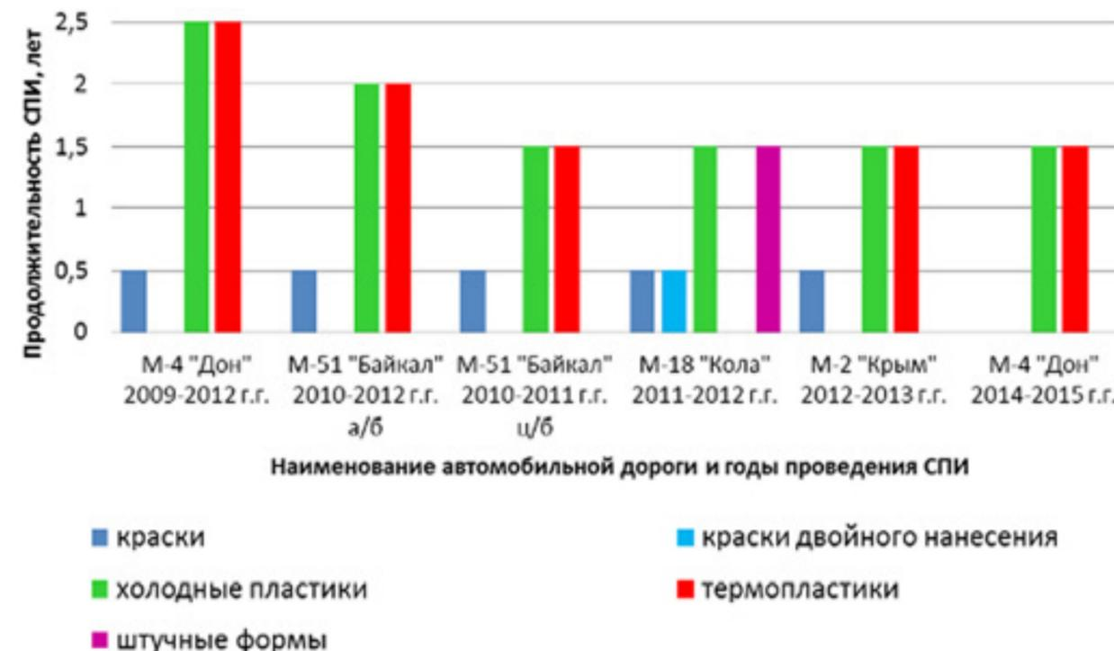
Рис. 1. Продолжительность проведения сравнительных полевых испытаний и типы материалов (изделий) для дорожной разметки, представленных на СПИ в период 2009–2015 гг.
