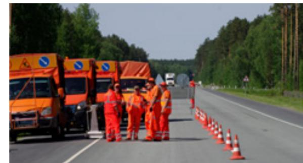
Рис. 2. Разметочные машины для нанесения красок (эмалей) ООО «Технотор» перед нанесением контрольных линий
