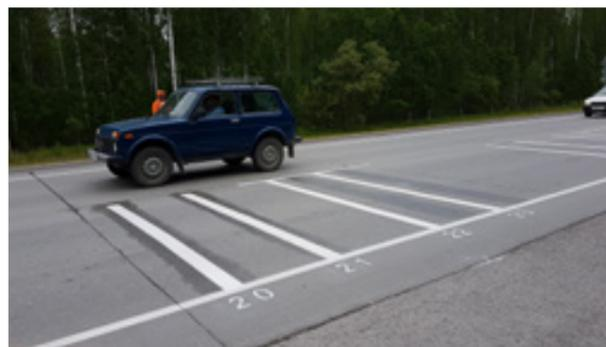
Рис. 4. Контрольные линии, выполненные термопластиками на участке с цементобетонным покрытием (№ 20, 21 – с подгрунтовкой – праймером, № 22, 23 – без подгрунтовки – праймера)
