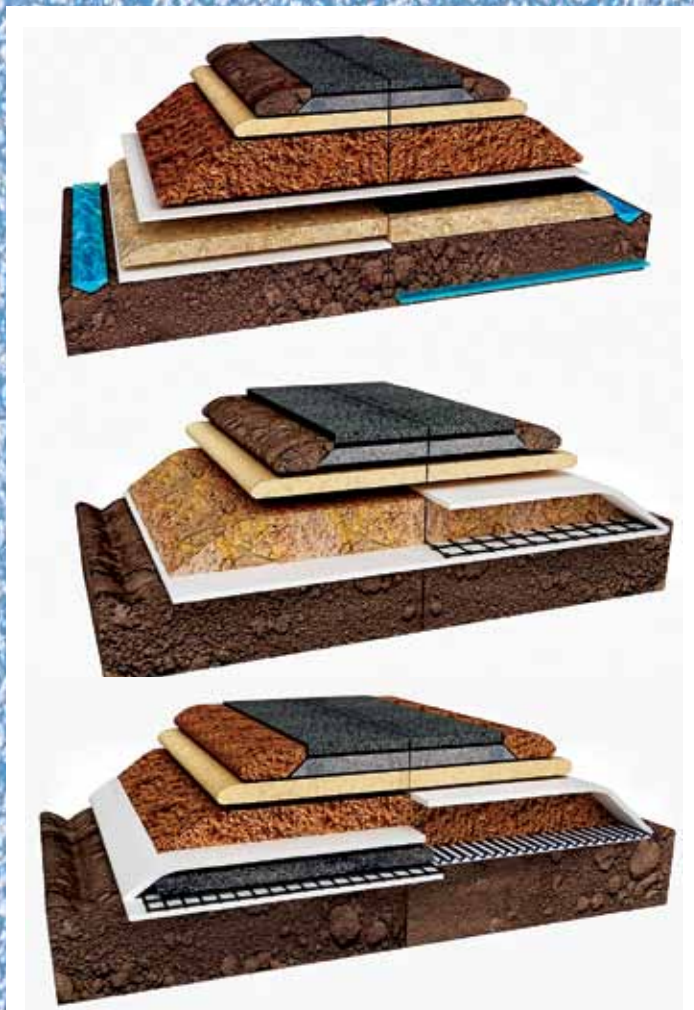
Варианты применения геосинтетических материалов в конструкции дорожной одежды
