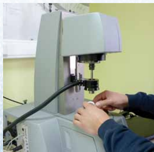
Установка образца на плиту динамического сдвигового реометра для выполнения испытаний по определению реологических свойств
