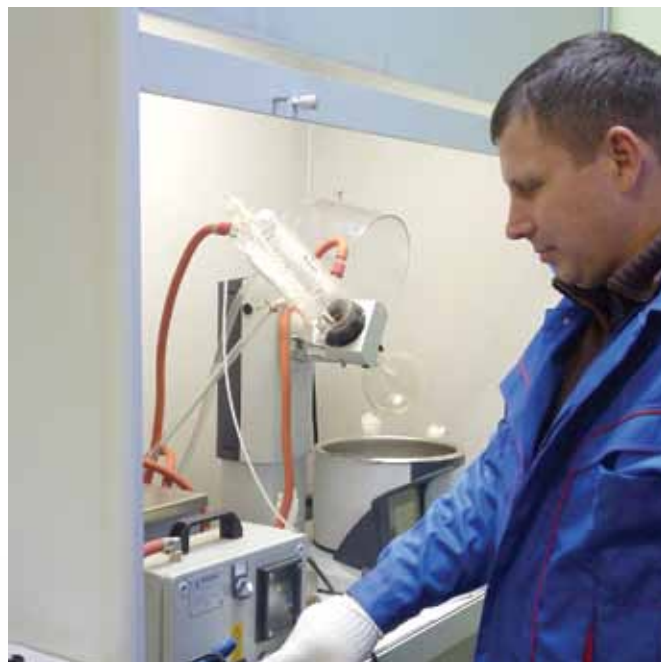
Работа с ротационным выпаривателем по извлечению битума после процесса экстрагирования
