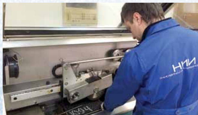
Подготовка установки для определения колеобразователя асфальтобетона методом прокатывания нагруженного колеса
