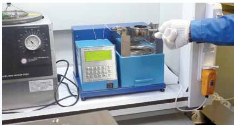
Установка тигля с образцом в аппарат для определения температуры вспышки
