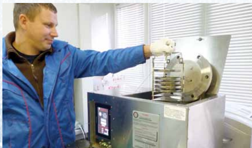
Подготовка битумных образцов методом длительного старения под высоким давлением в печи PAV
