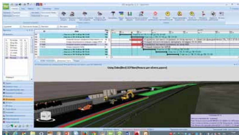
Рис. 1. 4D-модель строительства автомобильной дороги
