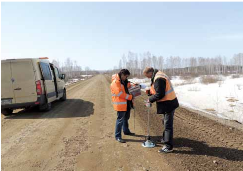
Определение несущей способности конструкции дорожной одежды
