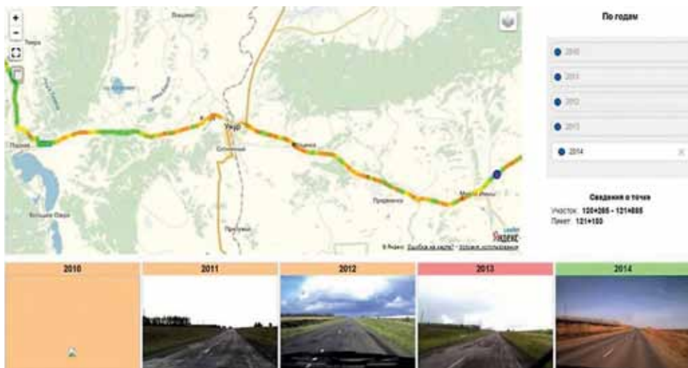
Состояние покрытия. Шарыпово – Ужур – Балахта
