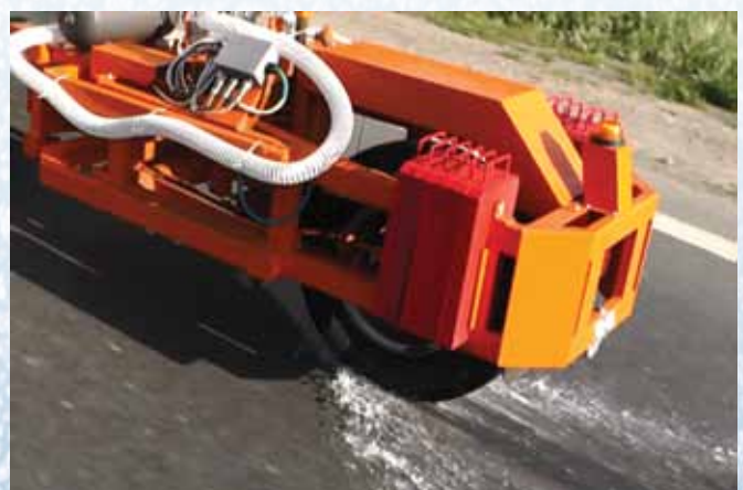
Рис. 5. Новый ПКРС-2 РДТ+ с насадкой увлажнения по ГОСТ 33078–2014
