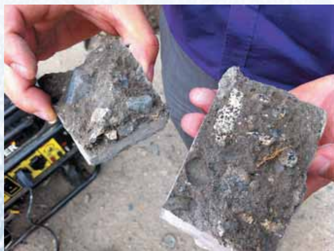
Ремонт дороги по технологии «холодный ресайклинг». Новосибирская область, 2012 год
