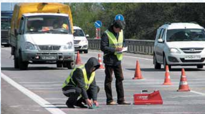
Контроль колориметрических и фотометрических параметров контрольных линий на сравнительных полевых испытаниях
