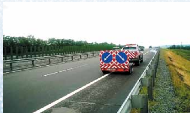
Рис. 3. Проведение диагностики прочности дорожных одежд на участках автомобильной дороги М-4 «Дон» с использованием FWD Primax
