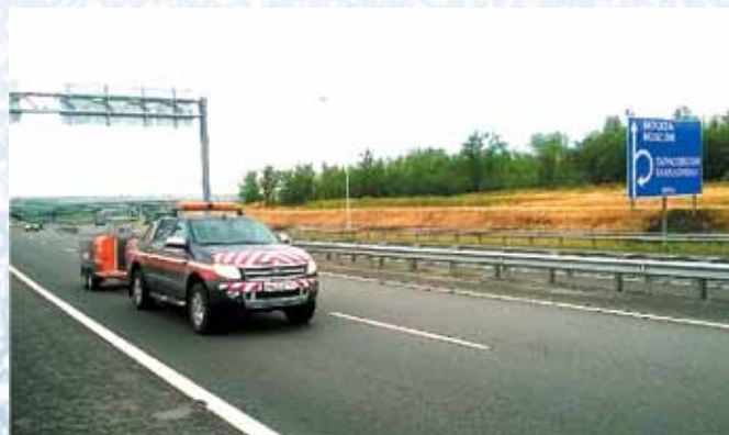
Рис. 3. Проведение диагностики прочности дорожных одежд на участках автомобильной дороги М-4 «Дон» с использованием FWD Primax
