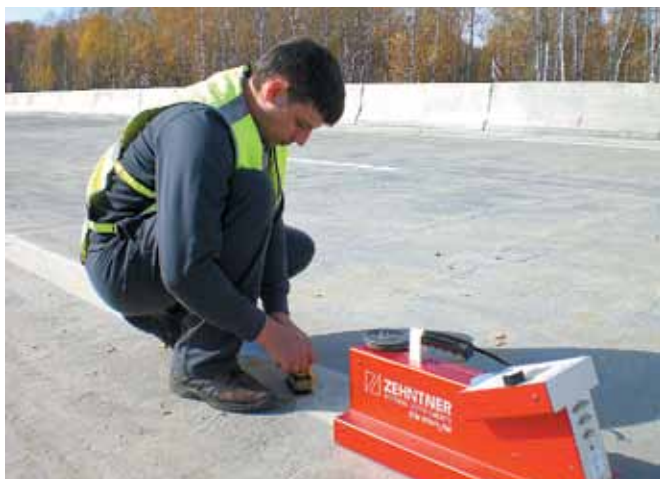
Инструментальный контроль эксплуатационного состояния горизонтальной дорожной разметки
